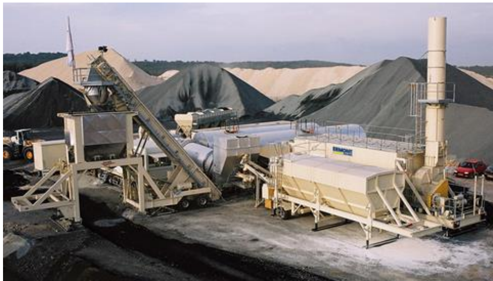
Illustration n° 6 : Photographie d'un poste d'enrobage de type TSM21
